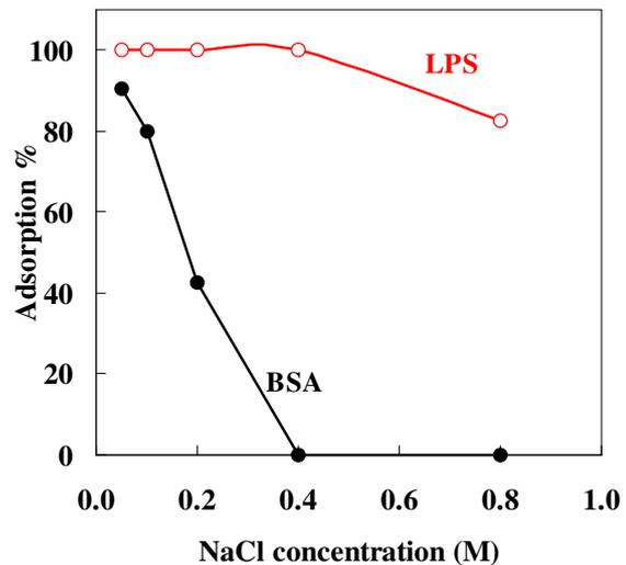
エンドトキシン吸着試験はバッチ法による吸着で評価した。湿潤ゲル0.2gを2mLのサンプル溶液 (BSA: 500  $\mu\text{g/ml}$ , *E. coli* 0111: B4 LPS: 100 ng/ml, pH 7.0, NaCl 濃度: mol/L = 0.05-0.8) に加えて上清を回収して評価した。
