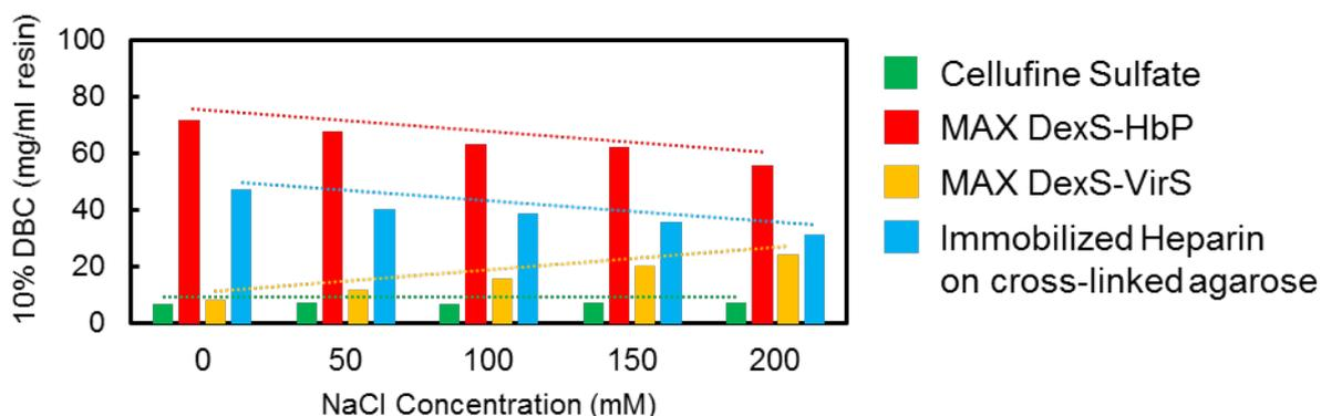
内径 5 mm x 高さ 2.5 cm のカラムに充填剤を充填し、10 mM リン酸ナトリウムバッファー pH 7.5 + 0、50、100、150 mM NaCl で平衡化しました。ラクトフェリン (2 mg / ml) を上記のバッファーに溶解してサンプル溶液を調製した後、0.125 ml / min の流速で 4 分の滞留時間でカラムにロードしました。各バッファー条件でのタンパク質ブレイクスルー曲線から、10%DBC (mg / ml レジン量) が推定されました。サンプルロードの合間に、カラムを上記の緩衝液 + 1.0M NaCl で溶出した。
