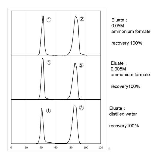
Column : 1.5x50cm (Vt=88ml) Gel : Cellufine<sup>®</sup> GH-25 Sample : 2ml ①Lysozyme 25mg ②NaCl 125mg Flow rate : 33ml/hr ( 18.6 cm/hr) Detection : A280nm(Lysozyme) Silver nitrate titration method法 (NaCl)
