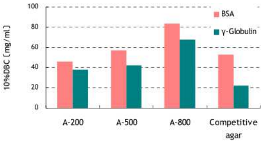
图 7. 在 Cellufine 弱阴离子 IEX 介质和竞争介质中均添加 DBC 模型蛋白 色谱柱：5mm 内径×50mm 长 流速：150cm/h 样品：1mg/ml 缓冲液：免疫球蛋白 G 采用 50 mM Tris-HCl (pH 9.5) 牛血清白蛋白采用 50 mM Tris-HCl (pH 8.5)
