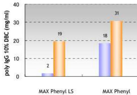
图 7. Cellufine MAXPhenyl 在不同盐浓度下的单克隆抗体免疫球蛋白 G 的动态结合载量
