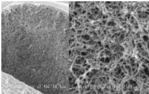
图 1. Cellufine MAX 基体树脂 SEM 分析
