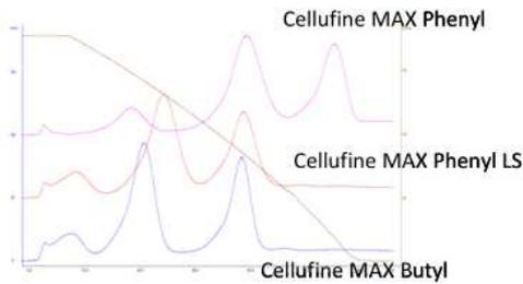
图 4. Cellufine MAXButyl 与 Phenyl 的模型蛋白分离
