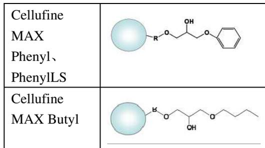
图 2. Cellufine MAX HIC 颗粒结构
