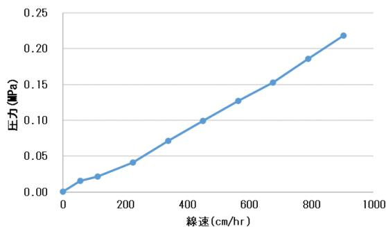
图 3 Cellufine Phenyl EX 的流速特性
